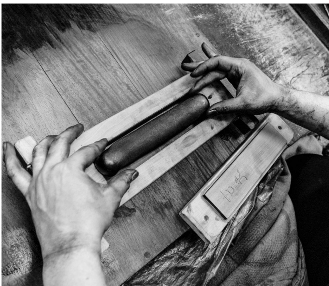
【写真5】棒状に延ばした墨を木枠に入れる
